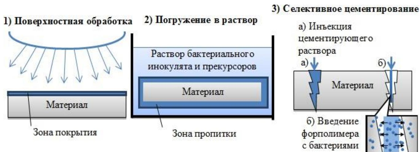
**Рисунок 1.3** – Методы локальной обработка бетонных изделий [13]
