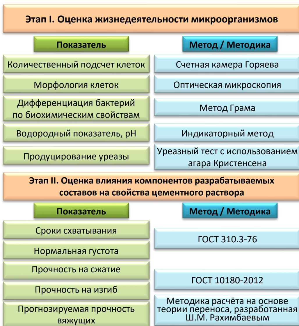
**Рисунок 3.1** – Декомпозиция изучения продуцирующей способности бактерий-инициаторов карбонатной биоминерализации, разработки и исследования влияния биоминерализующего состава на цементную систему
